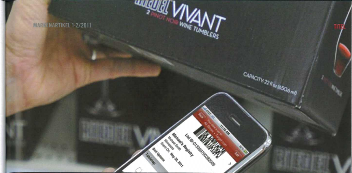
Quick Response-Codes: Liest der Verbraucher die mehrdimensionalen Barcodes mit der eingebauten Kamera seines Telefons ein, können auf dem Bildschirm umfangreiche Produktinformationen angezeigt werden. Häufig sind darin Links zu Webseiten mit Zusatzinfos enthalten.
